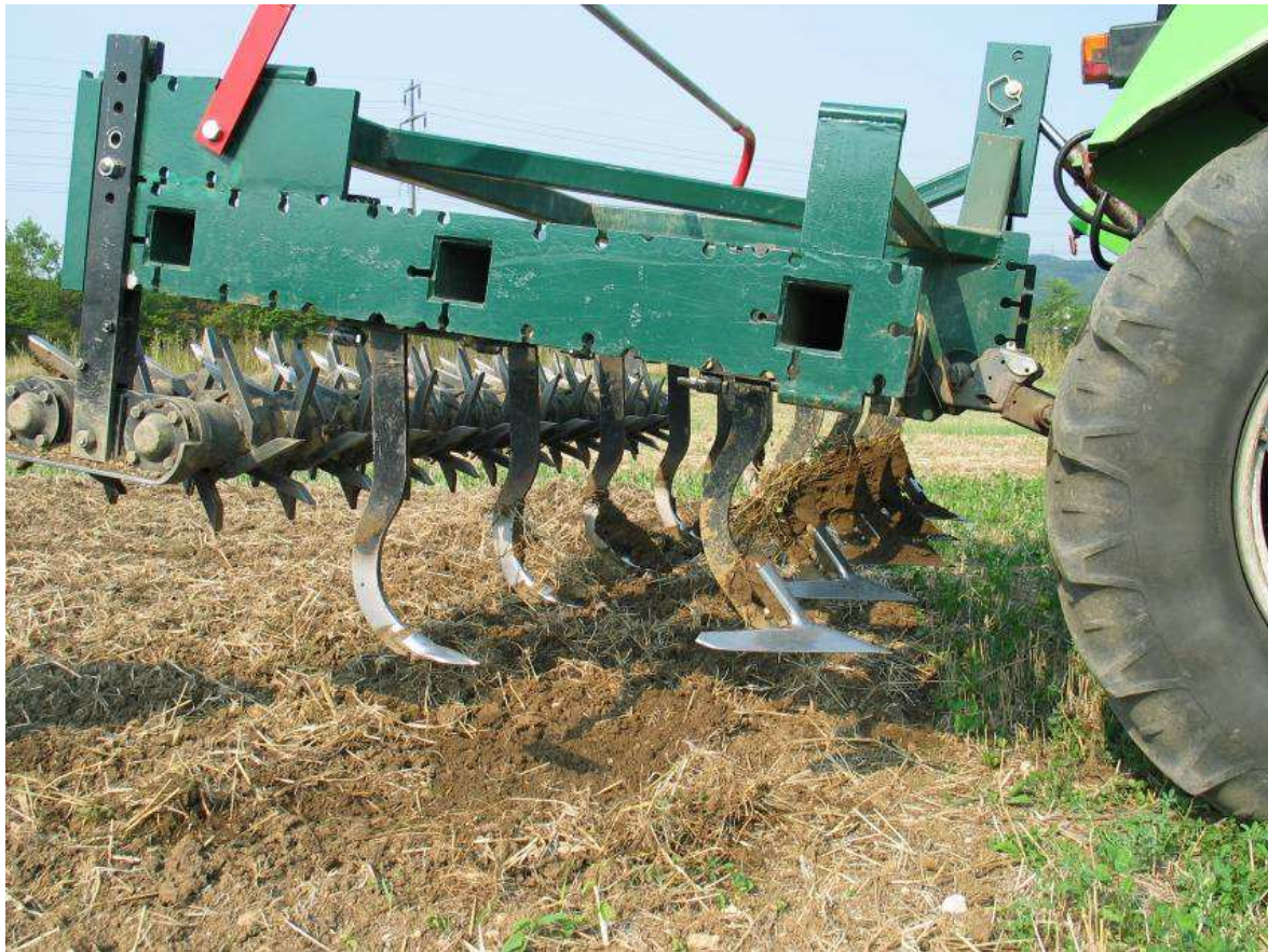
Abb. 2: Wecodyn-Grubber; Gänsefußscharen können flach gegen Unkraut eingesetzt werden, mit den schmalen, tiefer arbeitenden Zinken wird der Boden gelockert. Der Nachläufer dient zum Ausebnen und Rückverfestigen des Bodens. Dank der Zahnwalze kann der Grubber auch am Hang eingesetzt werden. (Foto: Dierauer, FiBL)
